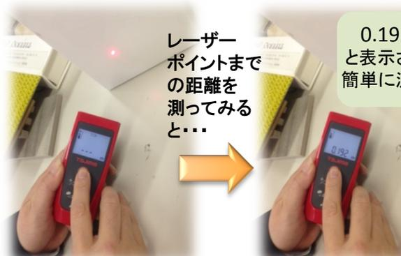
レーザー距離計(タジマF05)簡易機種でも約5cm~50mまで測定可能...軽くて便利
